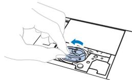
**9** Utilice el cepillo de limpieza o una aspiradora para eliminar toda la pelusa y el polvo de la guía y del sensor del hilo de la bobina y la zona de alrededor.
