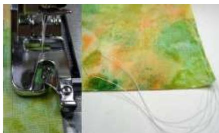
2. Realizar un doble dobléz de 4mm en el borde del dobladillo. Levantar ligeramente la tela y ubicarla en el borde del rulo. Continuar para guiar la tela, tirando de los hilos y coser el dobladillo hasta llegar al final.
