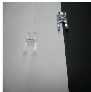
Este prensatela es útil para coser aplicaciones, o cuando se cose siguiendo líneas de guía o sobre el papel. (ejemplo Técnica Paper piecing). La apertura del pie prensatela y la marca central nos permite visualizar la ubicación de la puntada en la tela.
