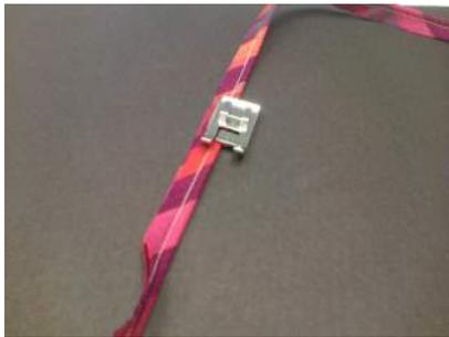
Este prensatela es útil para fijar ribetes o cordones en bolsas o almohadones. Los canales del prensatela mantienen fijo el ribeteado a medida que se cose; esto resulta especialmente útil cuando se colocan cordones entre dos trozos de tejido y después se cosen en su posición.
